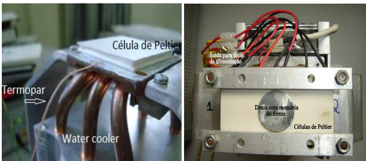
Figura (3) – Esquema genérico do funcionamento da máquina térmica parcial e completa com o disco
